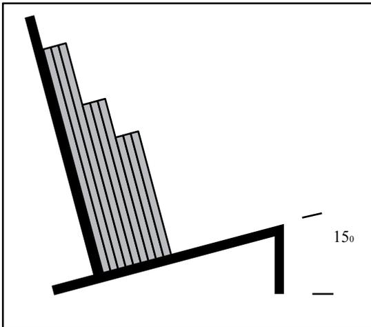
IMPACTAMR deber ser almacenada preferentemente en posición vertical, en estantes o caballetes ligeramente inclinados con un ángulo aproximado de 15 grados y una base de paneles de madera; de esta manera las caras del material descansarán sobre toda la superficie, evitando el pandeo o deformación y facilitando su manejo.
