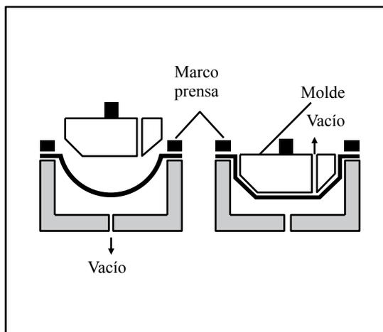
Formado a presión con ayuda de pistón molde hembra y vacío
