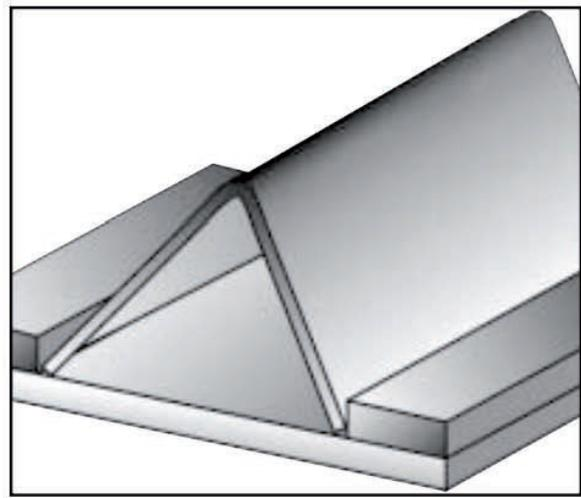
Utilice plantillas fijas o ajustables para mantener la pieza en el ángulo deseado.
