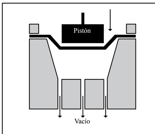
Independientemente de la técnica de termoformado que se utilice, es recomendable en todos los casos que los moldes siempre muestren superficies libres de basura o imperfecciones, debido a que cuando IMPACTAMR se encuentra al punto de revenido copia cualquier detalle del molde. El acabado de moldes determinará la calidad final de la pieza terminada.
